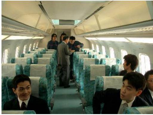
もともとリニア列車自体にも強い懸念をもっていましたが、それが試乗によって現実となりました。**列車の室内は狭く**、普通特急の横四列のシートが入るだけの幅でした。列車窓側の側面も飛行機か普通特急列車のイメージをもっていましたが、全然、違っていました。私は指で何か所も叩いての「打音検査」をしましたが、**頑強で分厚い構造**でした。窓は飛行機よりもかなり小さく、窓は外付けと内付けの2重ガラスでガラス自体もかなり分厚い材質です。つまり騒音や電磁波などの影響を防止するためにこんな構造になっていると考えられます。
