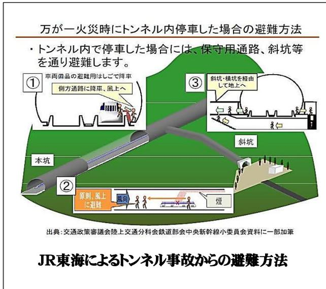
平成20年12月の中央リニア調査有識者委員会におけるとりまとめの概要でも、「エ、万一トンネルの途中で停止した場合の避難方法」として、「・新幹線と同様に車両に具備した梯子により車両から中央通路へ降りる。・中央通路からは階段を降り、シール
